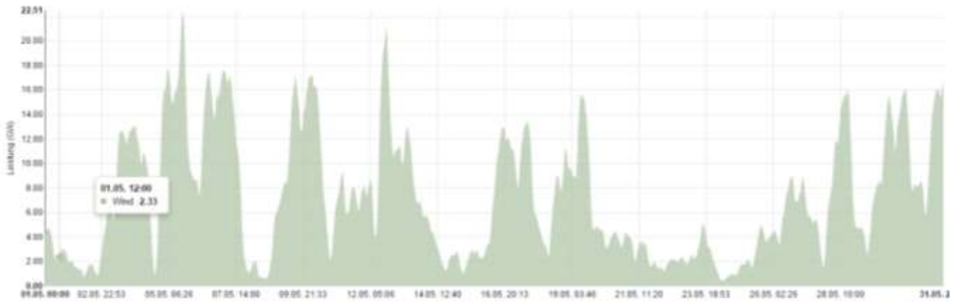
Production éolienne totale allemande, mai 2015. On observe la forte intermittence et la quasi-absence de production durant des périodes de plusieurs jours consécutifs. La puissance installée éolienne en Allemagne est de 37.3 GW (mi 2015) (source : www.energy-charts.de).
